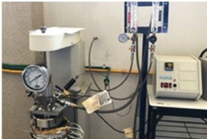
Fotografía 1. Reactor Tipo batch empleado en este proyecto.
